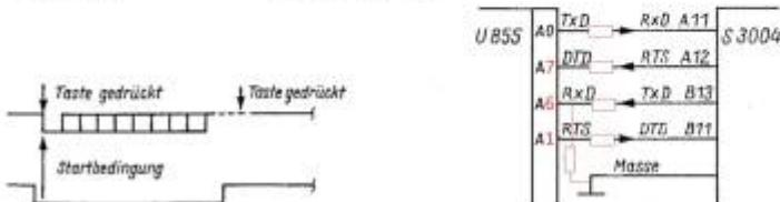
Bild 1: Anschlussbelegung der Interfacebuchse der S 3004
