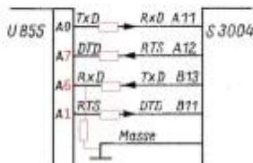
Bild 1: Anschlussbelegung der Interfacebuchse der S 3004
