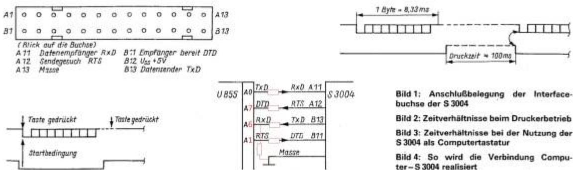
Angeschlossen wird die S 3004 über eine serielle Verbindung.
