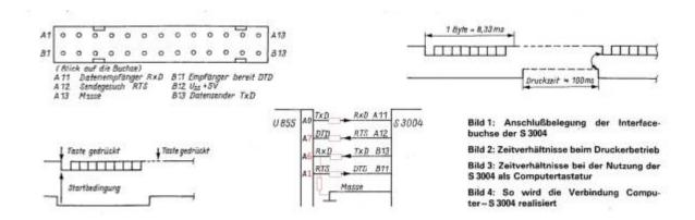
Angeschlossen wird die S 3004 über eine serielle Verbindung.
