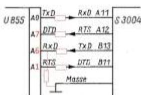
Bild 1: Anschlussbelegung der Interfacebuchse der S 3004
