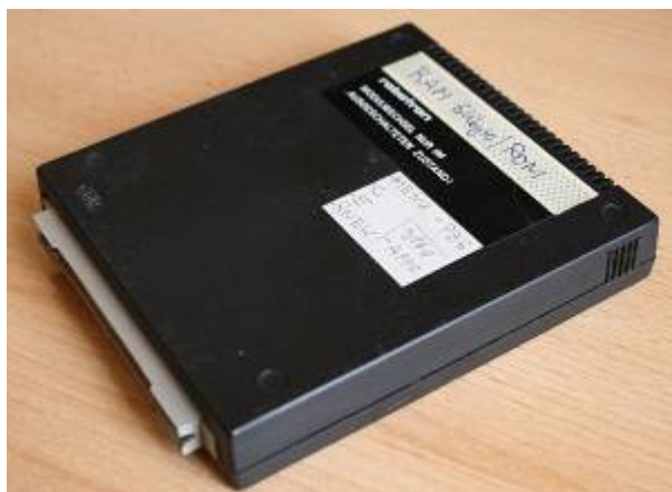
Ein umgebautes ROM-Modul mit RAM, enthält PZG/RNEW, MENU (HC-CAOS von D. Ambras), C, E (Speicher-Inhalt PZGOK.kcc) (Besitzer A.S.)
