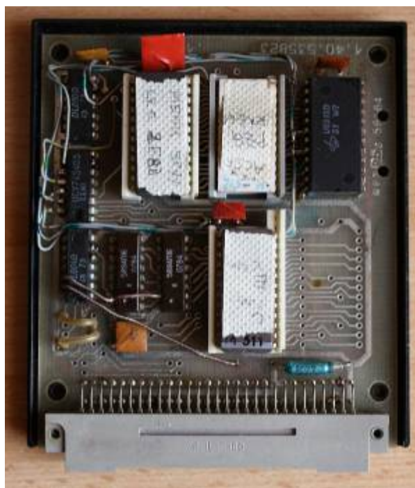
Ein umgebautes ROM-Modul mit RAM, enthält PZG/RNEW, MENU (HC-CAOS von D. Ambras), C, E (Speicher-Inhalt PZGOK.kcc) (Besitzer A.S.)
