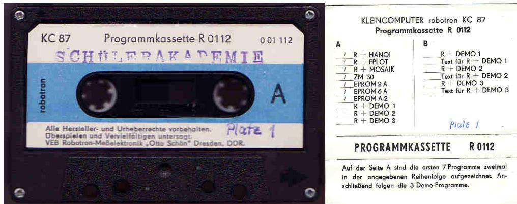
Als Massenspeicher kommt beim KC ein Kassettenrekorder zum Einsatz. Gespeichert wird auf Musikkassetten. Ein Filesystem gibt es nicht, der Nutzer muss sich z.B. im Kassetteneinleger notieren, welche Programme in welcher Reihenfolge auf der Kassette gespeichert sind.
