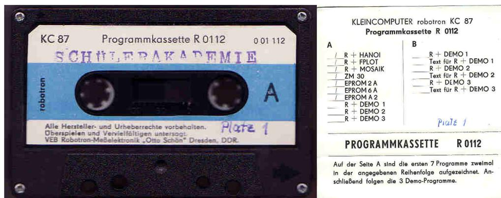
Als Massenspeicher kommt beim KC ein Kassettenspieler zum Einsatz. Gespeichert wird auf Musikkassetten. Ein Filesystem gibt es nicht, der Nutzer muss sich z.B. im Kassetteneinleger notieren, welche Programme in welcher Reihenfolge auf der Kassette gespeichert sind.
