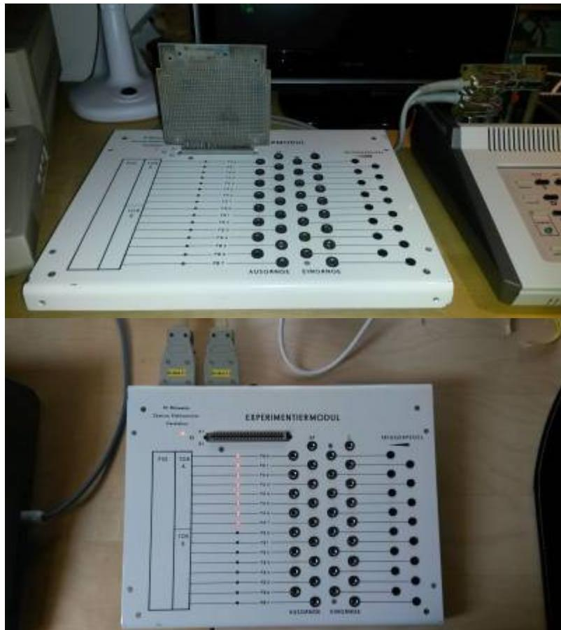
Wie auf den Bildern zu sehen ist, wird das Experimentiermodul direkt an ein (modifiziertes) [E/A-Modul](#) angesteckt. Jeder Pin der PIO ist über eine Diodenbuchse erreichbar. Eine LED signalisiert den Pegel. Eingangsseitig sind Trigger enthalten (s. Gerätedokumentation)
