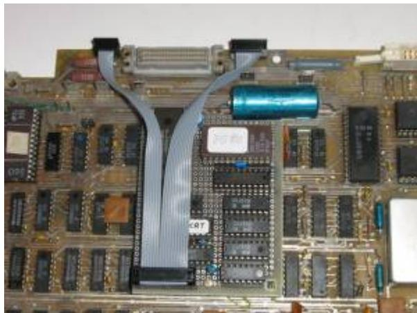
Derzeit ist bei mir ein Musteraufbau von U. Zander im Test. Dieser ist mit einem GAL aufgebaut und enthält alle 3 Module:
