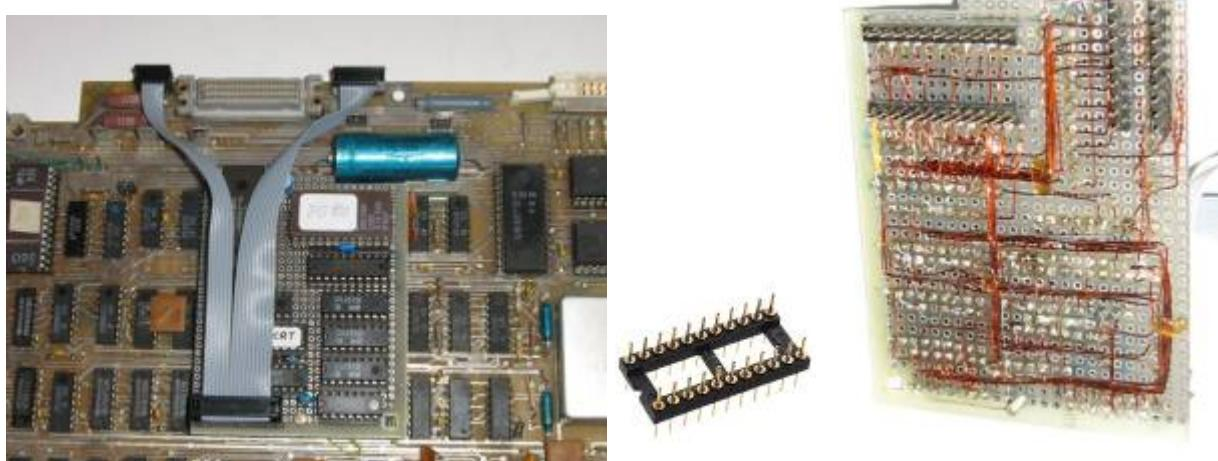
Derzeit ist bei mir ein Musteraufbau von U. Zander im Test. Dieser ist mit einem GAL aufgebaut und enthält alle 3 Module:
