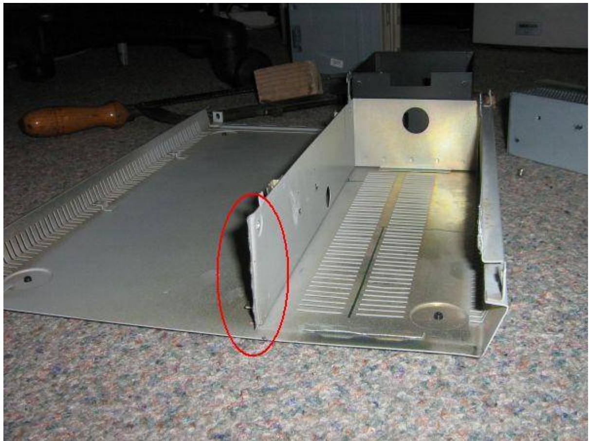
Für die Befestigung des Netzteils werden zwei Löcher gebohrt, rechts im Bild sieht man den umgebogenen Streifen der ehemaligen Stirnseite. Am rot umrandeten Platz wird dann das Seitenteil (schwarzes Plaste) untergeschoben.
