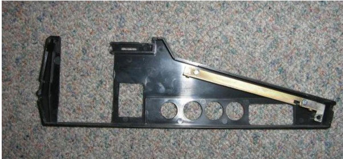
Ansicht von außen. Der Blechwinkel, an dem die Tastaturabdeckung angeschraubt war, wurde mit zersägt und dann mit Sekundenkleber an seinem alten Platz befestigt.
