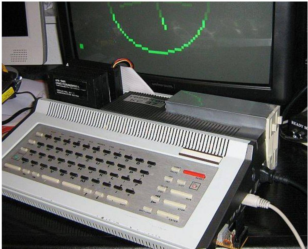
Fertig: Ein Abdeckung aus Weißblech (Bierdose - extra dafür gekauft) zierte die Floppies. CP/M läuft, vorn rechts am Gerät sieht man noch mein SD-Karten-Anschluß für CP/M (8 MByte !!)
