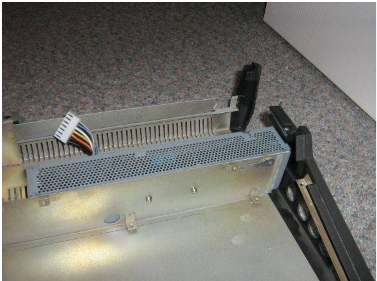
Bohrungen für die Floppys. Ich hatte zuerst die jeweils linken Löcher gebohrt. Beim Einbau der Floppys stellte sich heraus, dass dann der Auswurfknopf für die Floppys unten und direkt hinten dem Netzstecker liegen würde. Deshalb wurde noch mal umgebaut und die jeweils rechten Löcher gebohrt, so dass die Floppys um 180° gedreht werden konnten.
