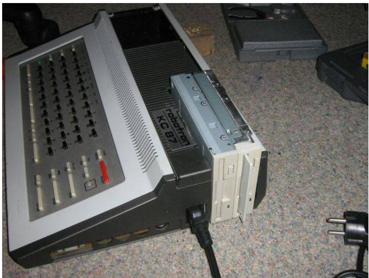
Es fehlt jetzt nur noch eine Abdeckung für die Floppys. Hier ist ein Entwurf aus rotem Papier. Hinten im KC sieht man Boot-Modul, 64K-Modul, RAF2008 und Floppy-Modul stecken.
