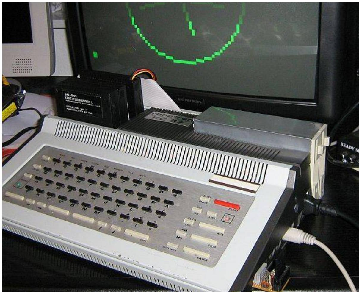
Fertig: Ein Abdeckung aus Weißblech (Bierdose - extra dafür gekauft) zierte die Floppies. CP/M läuft, vorn rechts am Gerät sieht man noch mein SD-Karten-Anschluß **SD-Card** für CP/M (8 MByte !!)
