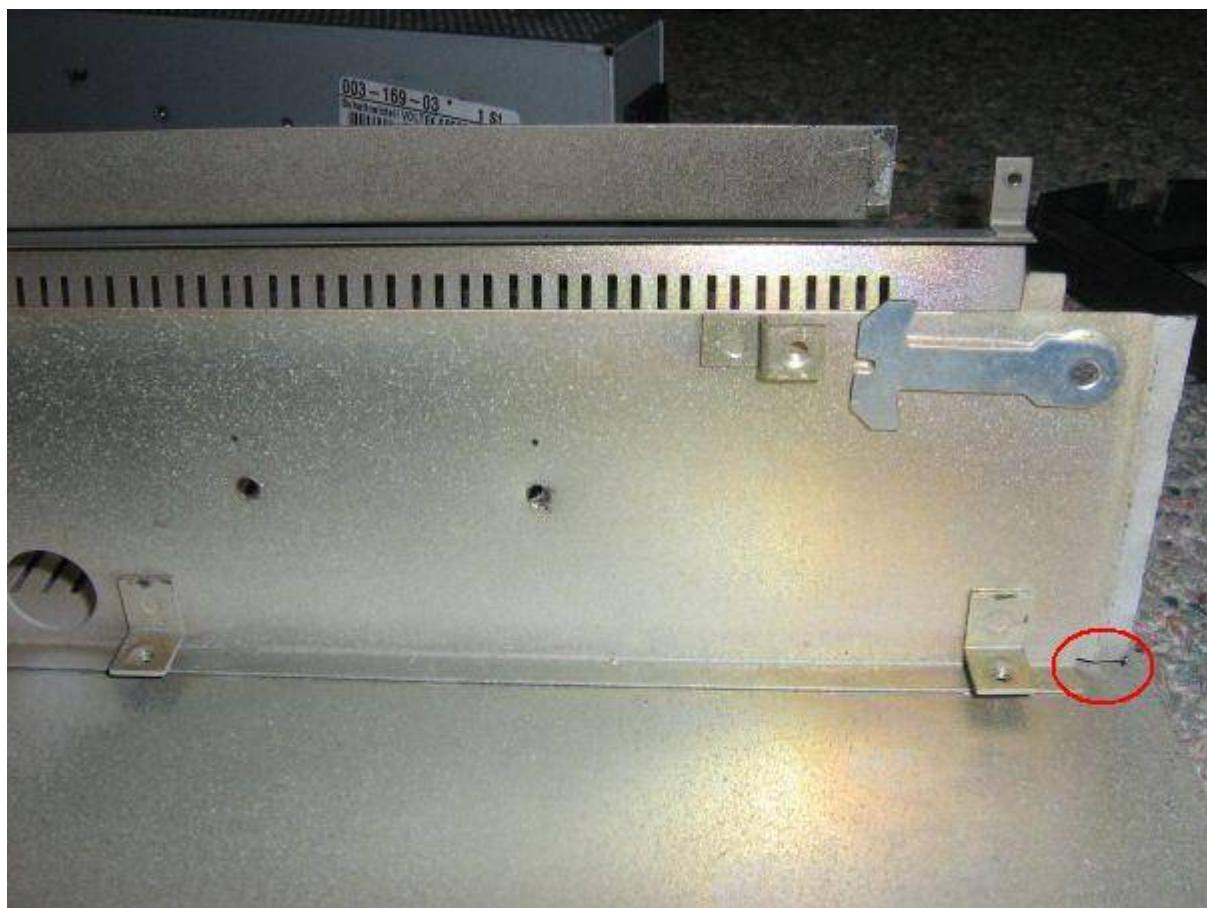
Das Seitenteil erhält Aussparungen für 2 Floppys und den Netzstecker (IEC-Buchse)
