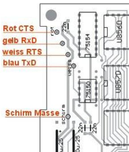
Das Druckermodul sollte man so umbauen, dass es als vollwertiges V24-Modul genutzt werden kann (s. unten und [Beschreibung 192K-Modul](#)): Für eine vollständige V24-Schnittstelle sind lediglich alle vorhandenen Anschlüsse auch zu nutzen. Selbst im angebauten Kabel sind noch Adern frei!
