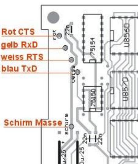
Noch ein Tipp: Das Druckmodul sollte man so umbauen, dass es als vollwertiges V24-Modul genutzt werden kann (s.a. [Beschreibung 192K-Modul](#)): Für eine vollständige V24-Schnittstelle sind lediglich alle vorhandenen Anschlüsse auch zu nutzen. Selbst im angebauten Kabel sind noch Adern frei!
