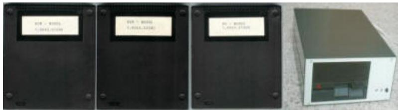
Als professionelle Varianten für den Betrieb von CP/M am Z9001 gibt es mindestens zwei Lösungen: zum einen die drei Rossendorfer Module und zum anderen die drei Module von Robotron. Die Robotron-Variante basiert auf den Entwicklungen aus Rossendorf.
