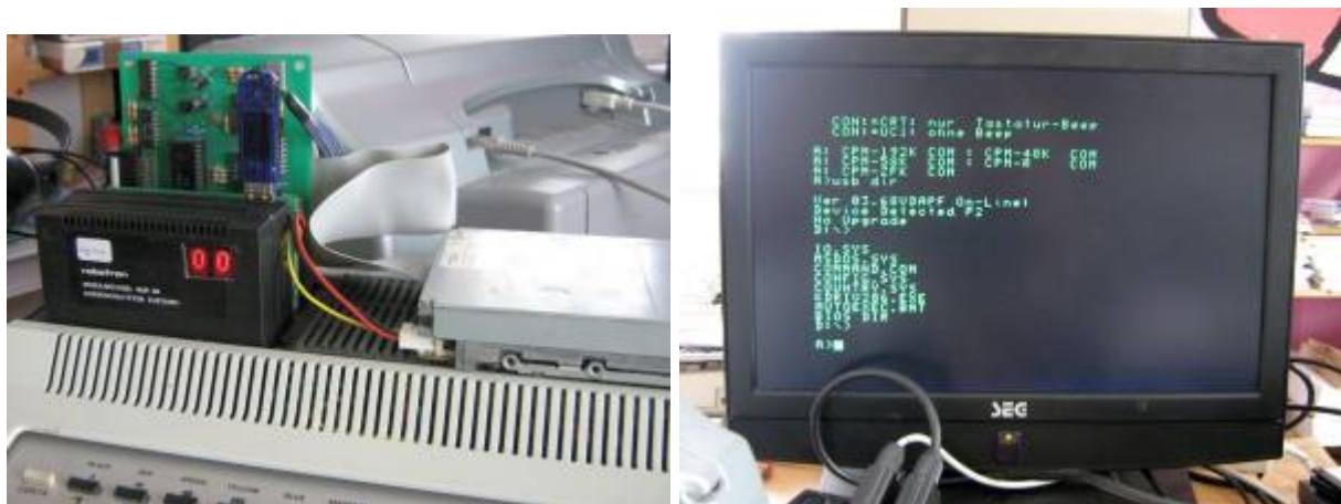
am KC mit Mega-Modul und BIC/KC-Floppymodul; Start von USB unter CP/M.
