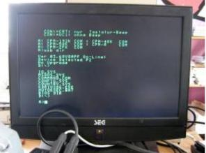
am KC mit Mega-Modul und BIC/KC-Floppymodul; Start von USB unter CP/M.
