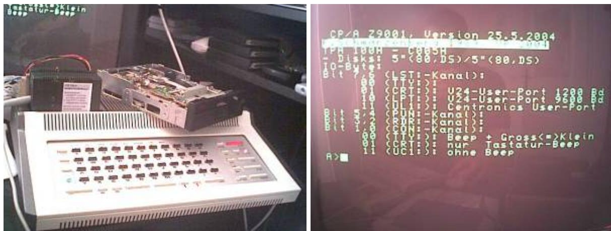
wie bei den obigen Lösungen eine Datei @CPMZ9 von Diskette geladen und gestartet. Als Alternative zum speziellen 64K-RAM-Modul werden in meiner Lösung die RAM-Speicherbänke des 192K-Moduls genutzt. Es steht sogar noch eine 24K-RAM-Disk zur Verfügung!
