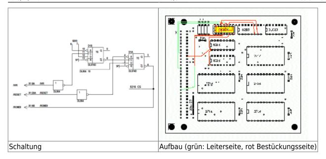
Zum Testen des Moduls kann ein spezieller Test-ROM → schaltrom.zip gebrannt werden. Das Modul muss sich bei ordnungsgemäßer Funktion mit "EOS>" melden. Es kopiert Code in den RAM und erstellt so die beiden Befehle **F8** und **FC**. Sie führen einen Schreibzugriff auf die Adresse F800h respektive FC00h durch und zeigen den Speicher ab C000h an. Ein korrektes Modul sollte folgendes Bild ergeben:
