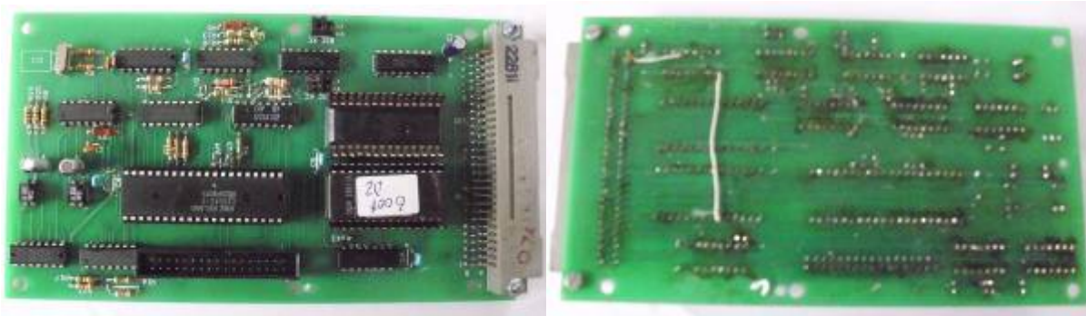
umgebautes BIC-Floppy-Modul mit BOOT-ROM
