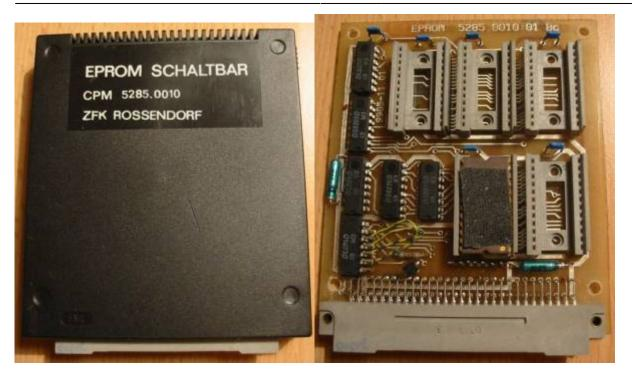
Der Modul belegt im ausgeschalteten Mode den Adressbereich von 0C000H bis 0E7FFH (nicht mehr veränderbar). Gegenüber dem ROBOTRON-Modul besitzt er aber die Möglichkeit, per Software (Speicher-Schreibbefehle auf bestimmten Adressbereich) zugeschaltet (aktiviert) bzw. abgeschaltet werden zu können. Ein abgeschalteter Modul erscheint dann wie ein nicht gesteckter Modul!
