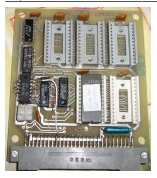
mit diesem Umbau wird ein **normales ROM-Modul** kompatibel zum BOOT-Modul der CP/M-Module.
