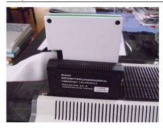
Eine weitere Variante ist der CP/M-Betrieb mit dem Floppy-Modul für den BIC. Die neuaufgelegte Platine von U.Zander ist durch Jumper auf 100% Kompatibilität zum robotron-Floppy-Modul umsteckbar.
