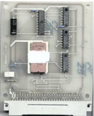
Das Boot-Modul belegt im zugeschalteten Zustand den Adreßbereich C000H bis C7FFH. Das Abschalten erfolgt mit einem Ladebefehl auf die Adresse FC00H, das Zuschalten durch RESET oder einen Ladebefehl auf die Adresse F800H. Die Daten werden dabei nicht ausgewertet.
