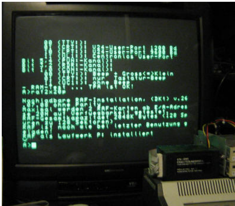
Meine RAF2008, mit 2MByte SRAM bestückt. Rechts ist der CP/M-Start und der Start des nachladbaren Treibers RAF2X20P.COM zu sehen.
