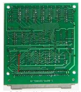
zusätzliche Verbindung am 64K-RAM-Nachbau-Modul (Leiterseite)
