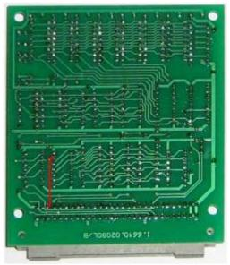
zusätzliche Verbindung am 64K-RAM-Nachbau-Modul (Leiterseite)
