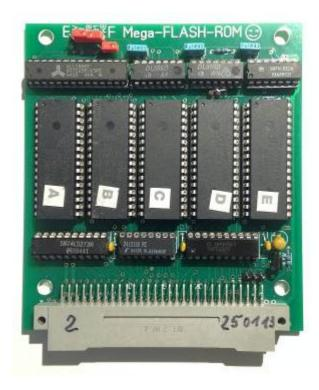
Anstelle des Boot-Moduls oder eines selbstgebauten Schalt-ROM-Modul kann auch ein Megamodul oder Mega-Flash-Modul genutzt werden. In der Modulsoftware sind die Programme
