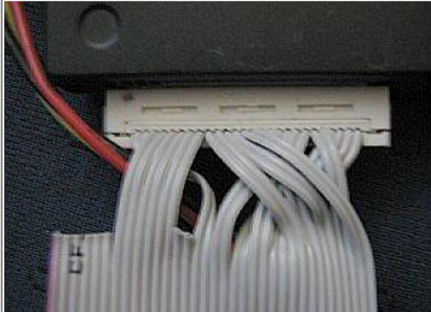
Das Kabel ist aus einem PC-Floppy-Kabel so gebaut, dass es zwei Laufwerke unterstützt. Dazu sind die Leitungen 10-13 an Laufwerk B vertauscht, und das drive-select Signal wird an das jeweilige Laufwerk geleitet. Wenn man auf Laufwerk B verzichtet, muss nix am Kabel verändert werden.
