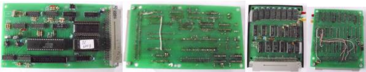
umgebautes BIC-Floppy-Modul mit BOOT-ROM, umgebautes 64K-RAM-Modul
