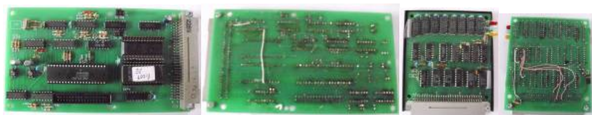
umgebautes BIC-Floppy-Modul mit BOOT-ROM, umgebautes 64K-RAM-Modul
