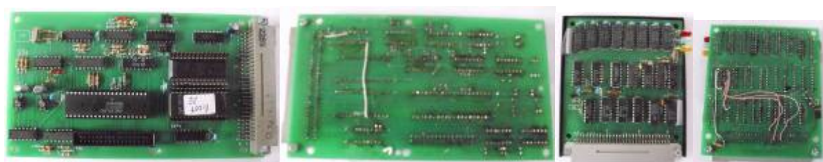
umgebautes BIC-Floppy-Modul mit BOOT-ROM, umgebautes 64K-RAM-Modul
