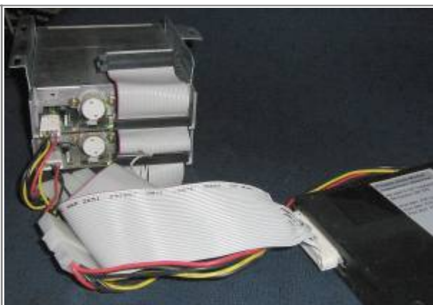
Die Laufwerke stecken in einem Floppyrahmen aus einem alten PC. Das obere Laufwerk ist A, darunter B. Anstelle des 3.5,-A kann ich an den Steckverbinder auch mein 800K-5 1/4“-Laufwerk anschließen.
