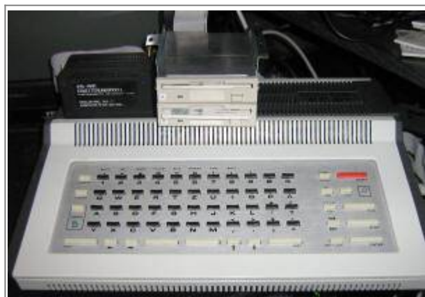
Mein aktueller Stand (März 2008): Ein 64K-Modul (Umbau eines 16K-Moduls durch U. Zander), mein Floppy-Modul und zwei 3,5“-LW sowie ein Boot-Modul (Umbau eines ROM-Moduls durch U. Zander).
