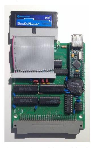
Die GIDE ist eine generische IDE-Schnittstelle für Z80-basierten Computer ("Generic IDE"). Sie ermöglicht den Anschluss von bis zu zwei IDE-Geräten wie Festplatten oder CD-ROMs. Zusätzlich wird auch eine batteriegepufferte Echtzeituhr (RTC, Seiko-Epson-72421) unterstützt. Die Schnittstelle wird über I/O-Befehle angesprochen.
