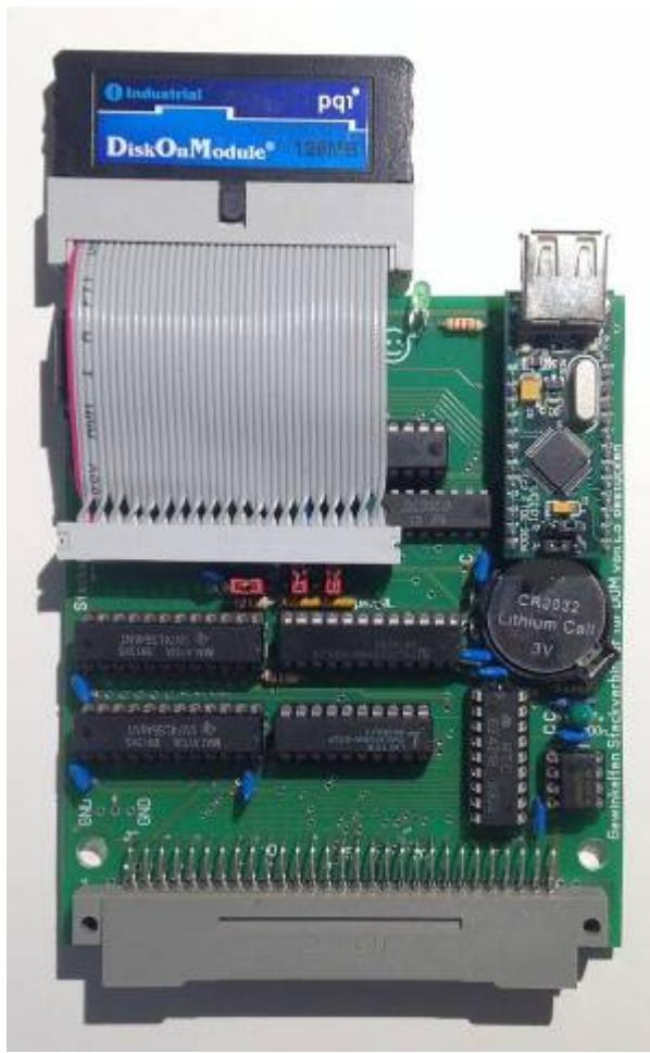
Die GIDE ist eine generische IDE-Schnittstelle für Z80-basierten Computer („Generic IDE“). Sie ermöglicht den Anschluss von bis zu zwei IDE-Geräten wie Festplatten oder CD-ROMs. Zusätzlich wird auch eine batteriegepufferte Echtzeituhr (RTC, Seiko-Epson-72421) unterstützt.
