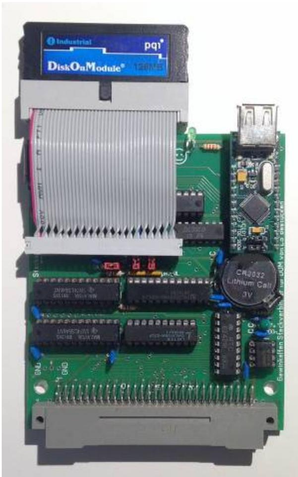
Die GIDE ist eine generische IDE-Schnittstelle für Z80-basierten Computer („Generic IDE“). Sie ermöglicht den Anschluss von bis zu zwei IDE-Geräten wie Festplatten oder CD-ROMs. Zusätzlich wird auch eine batteriegepufferte Echtzeituhr (RTC, Seiko-Epson-72421) unterstützt.
