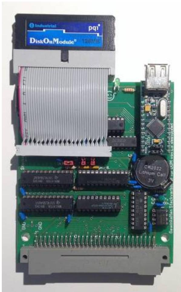
Am GIDE-Bus ist ein DOM-Modul vom Pollin angeschlossen. Der Flash-Speicher hat eine Kapazität von 128 MByte. Das reicht für satte 8 Laufwerke á 8 MByte.
