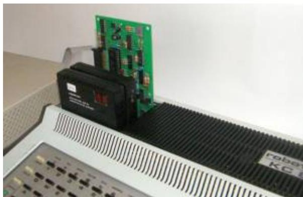
Die neu aufgelegte Platine von U.Zander ist durch Jumper auf 100% Kompatibilität zum robotron-Floppy-Modul umsteckbar (Port-Adressen). Zum Anschluss der Floppy-Laufwerke wird ein IBM-PC-Floppy-Kabel benötigt.
