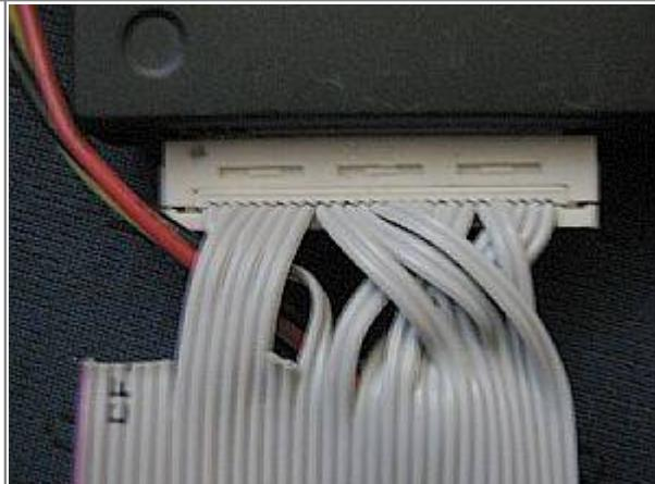
Das Kabel ist aus einem PC-Floppy-Kabel so gebaut, dass es zwei Laufwerke unterstützt. Dazu sind die Leitungen 10-13 an Laufwerk B vertauscht, und das drive-select Signal wird an das jeweilige Laufwerk geleitet. Wenn man auf Laufwerk B verzichtet, muss nichts am Kabel verändert werden.
