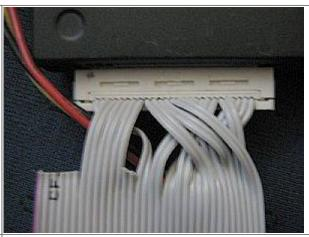
Mein Floppy-Modul 1.6640.02050 ist mit einer männl. Buchse bestückt, deshalb sieht es bei mir Gegenstück ist am Floppykabel ein Aufpressstecker (weibl.) dran, wo ich die einzelnen Kabel alle so hingebogen habe, dass sie am richtigen Anschluss landen. In originalen Modulen gehört der weibl. Steckverbinder zur Floppy auf die Platine)
