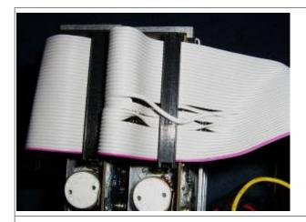
Das Kabel ist aus einem PC-Floppy-Kabel so gebaut, dass es zwei Laufwerke unterstützt. Dazu wohl mit Pin1 und Pin13 vertauscht aus. Als sind die Leitungen 10-13 an Laufwerk B vertauscht, und das drive-select Signal wird an das jeweilige Laufwerk geleitet. Wenn man auf Laufwerk B verzichtet, muss nichts am Kabel verändert werden.
