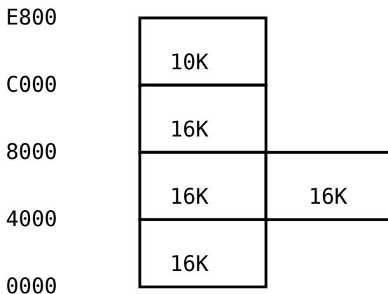
Die versteckte Bank wird vom BIOS für den sog. Disk-Transfer-Buffer sowie zum Halten einer Kopie des CCP (kein Laden von Diskette beim Warmstart!) genutzt. Damit sind je nach Größe des Diskbuffers (1K..8K je nach Generierung, Standard ist 1K) 3..10K der Bank vom BIOS genutzt. Die Belegung der Bank erfolgt von oben nach unten (ab 7FFFh abwärts).
