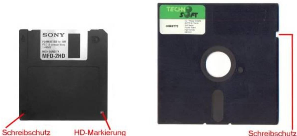
Bei 3½"-Disketten muss die Schreibschutzkerbe geschlossen sein, damit die Diskette beschrieben werden kann, Bei 5¼"-Disketten muss dagegen die Schreibschutzkerbe zu sehen sein, damit die Diskette beschrieben werden kann.
