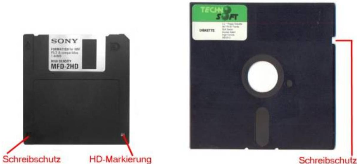
Bei 3½"-Disketten muss die Schreibschutzkerbe geschlossen sein, damit die Diskette beschrieben werden kann. Bei 5½"-Disketten muss dagegen die Schreibschutzkerbe zu sehen sein, damit die Diskette beschrieben werden kann.
