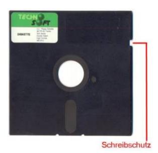
Bei  $3\frac{1}{2}$ "-Disketten muss die Schreibschutzkerbe geschlossen sein, damit die Diskette beschrieben werden kann, Bei  $5\frac{1}{4}$ "-Disketten muss dagegen die Schreibschutzkerbe zu sehen sein, damit die Diskette beschrieben werden kann.
