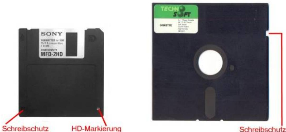
Bei 3½"-Disketten muss die Schreibschutzkerbe geschlossen sein, damit die Diskette beschrieben werden kann. Bei 5½"-Disketten muss dagegen die Schreibschutzkerbe zu sehen sein, damit die Diskette beschrieben werden kann.
