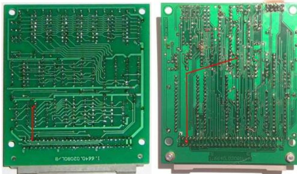
zusätzliche Verbindung am 64K-RAM-Nachbau-Modul (Leiterseite), 64K-SRAM-Modul (rechts)
