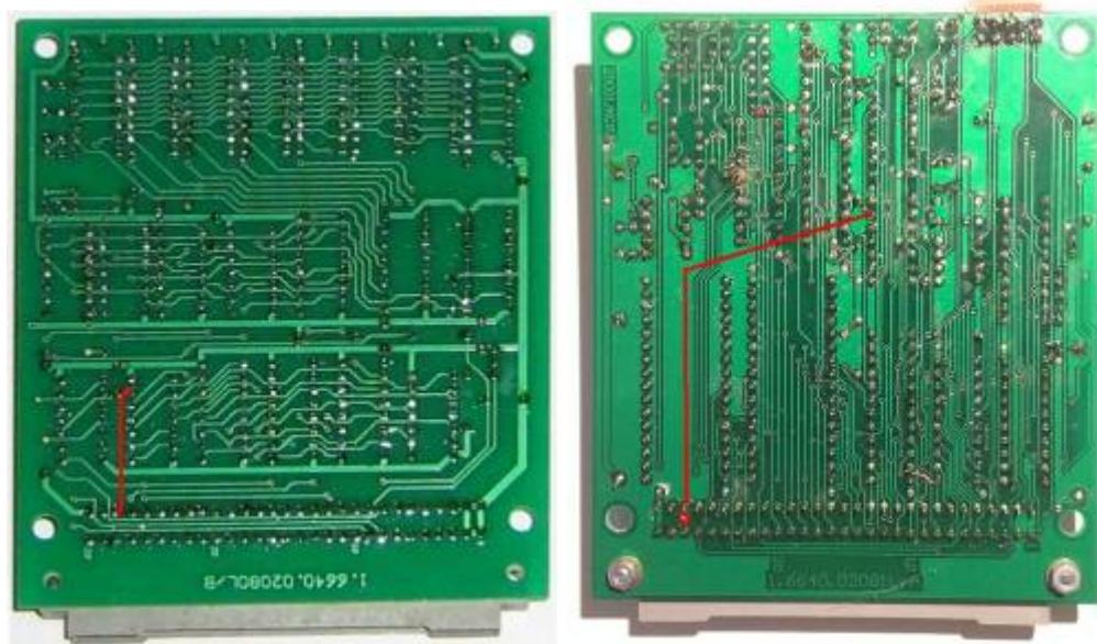
zusätzliche Verbindung am 64K-RAM-Nachbau-Modul (Leiterseite), 64K-SRAM-Modul (rechts)
