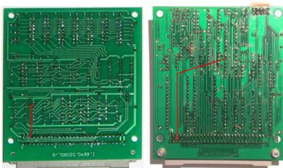
zusätzliche Verbindung am 64K-RAM-Nachbau-Modul (Leiterseite), 64K-SRAM-Modul (rechts)
