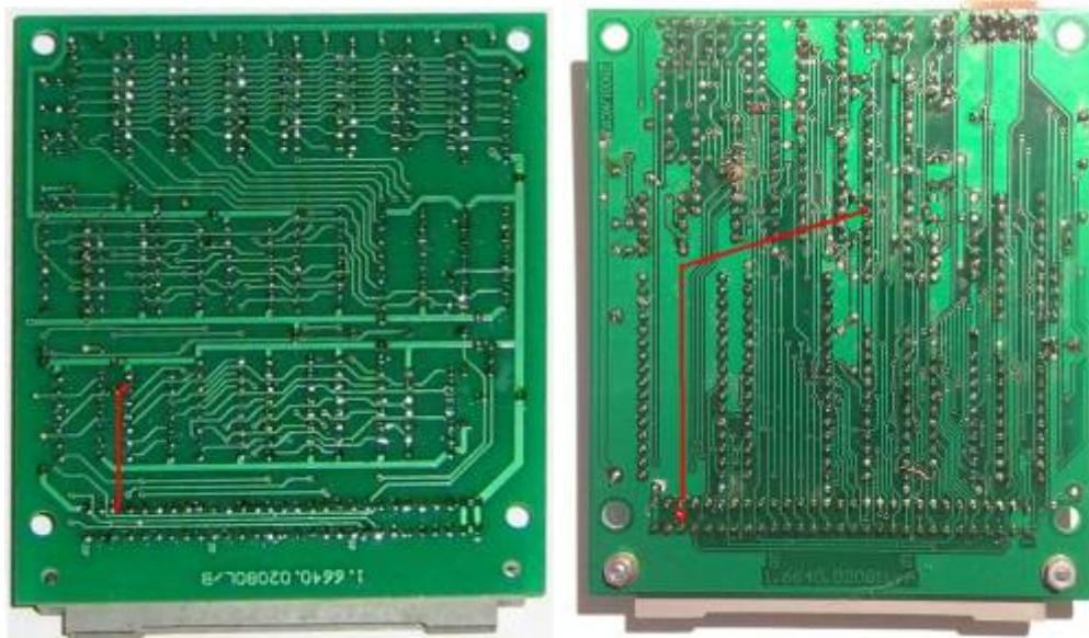
zusätzliche Verbindung am 64K-RAM-Nachbau-Modul (Leiterseite), 64K-SRAM-Modul (rechts)
