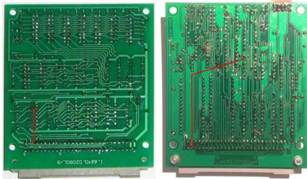
zusätzliche Verbindung am 64K-RAM-Nachbau-Modul (Leiterseite), 64K-SRAM-Modul (rechts)
