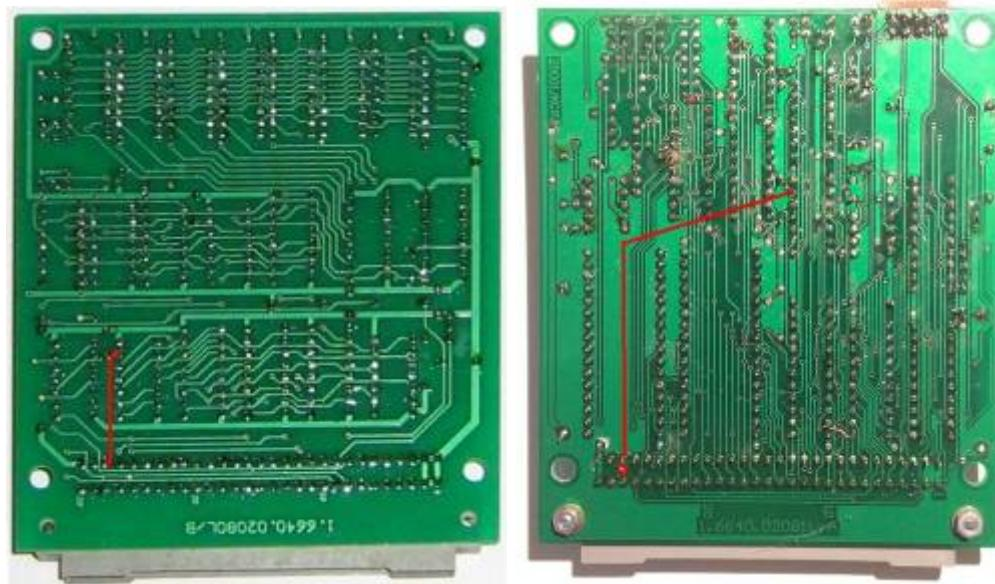
zusätzliche Verbindung am 64K-RAM-Nachbau-Modul (Leiterseite), 64K-SRAM-Modul (rechts)
