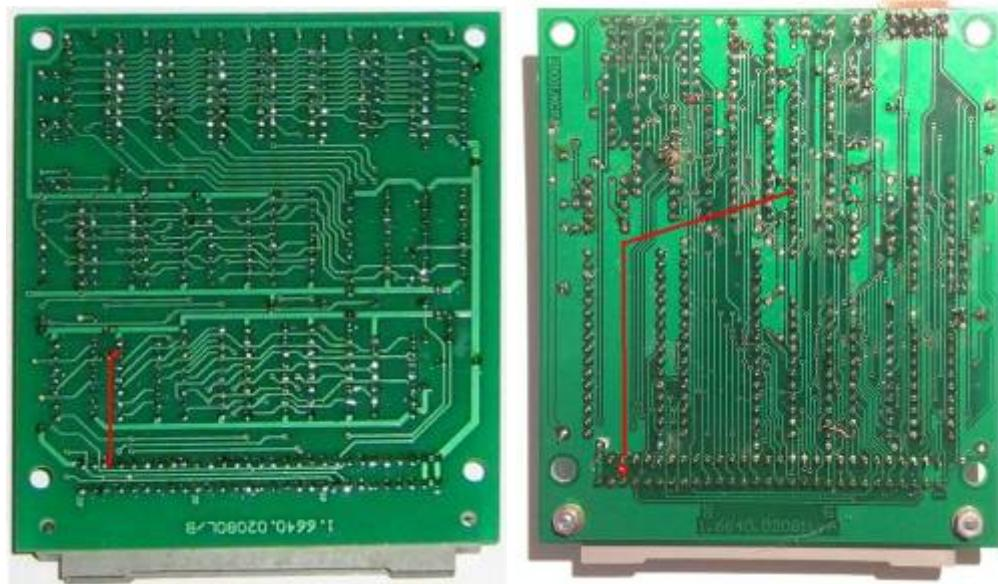
zusätzliche Verbindung am 64K-RAM-Nachbau-Modul (Leiterseite), 64K-SRAM-Modul (rechts)
