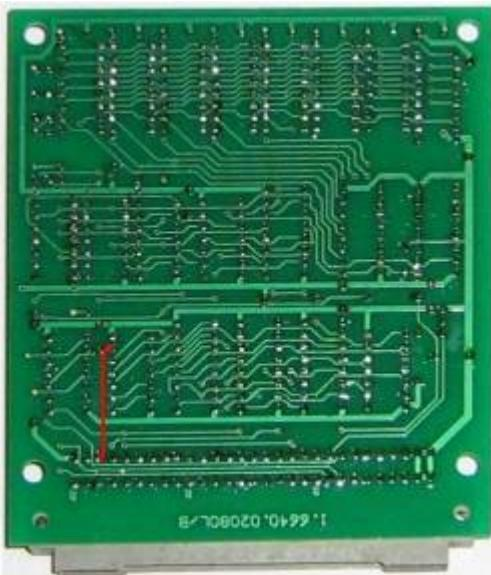
zusätzliche Verbindung am 64K-RAM-Nachbau-Modul (Leiterseite)
