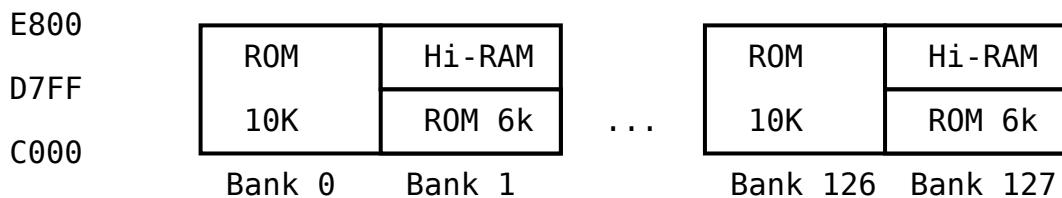
Beim Steuern der Zustände mit OUT-Befehlen werden bis auf OUT 75H keine Werte übergeben. OUT 75H wird zur Steuerung der ROM-Bänke benutzt.
