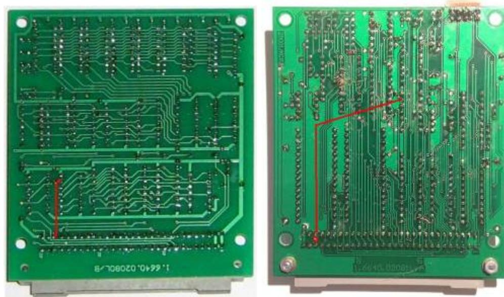
zusätzliche Verbindung am 64K-RAM-Nachbau-Modul (Leiterseite), 64K-SRAM-Modul (rechts)
