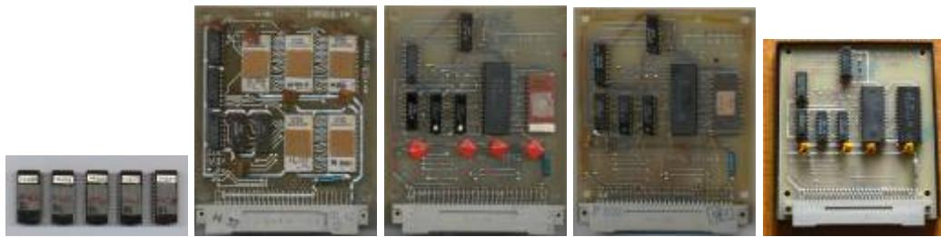
von links nach rechts: EPROMs M497 bis M501 (BASIC84), aus dem Nachlass der Entwickler (Besitzer: L.E.), ROM-BASIC mit 5x2K EPROM (BASIC85), mit 8K-PROM + 2K-EPROM (BASIC85), Plotter-Modul (BASIC86), Plotter-Module der TU Karl-Marx-Stadt (BASIC86).
